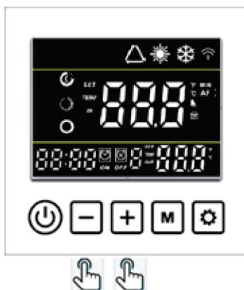
No controlador, pressione ou para ajustar a temperatura desejada da água de sua piscina, em seguida, pressione para salvar a configuração.
